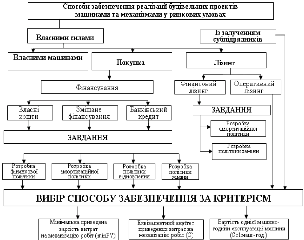
Рис.1. Механізм вибору ефективного способу забезпечення будівельного проекту машинами та механізмами за різними критеріями
